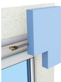
2 Découpe à la forme du caisson du volet roulant
