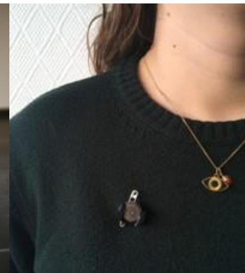
Mesures environnementales embarquées sur l'occupant : humidité, température radiante et d'air au voisinage du sujet
