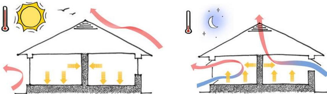
Schématisme du stockage diurne et déstockage nocturne par ventilation source : Night-Purge Ventilation
