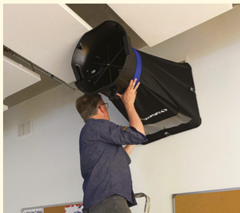
Mesure de débit avec un balomètre.
