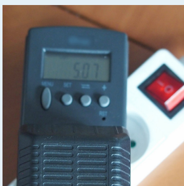
Exemple de suivi de consommation d'un poste informatique à l'aide d'un wattmètre. Source : Cerema
