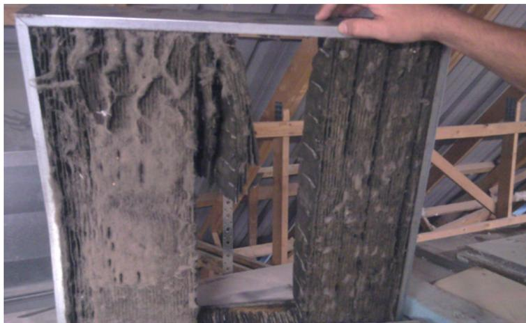
Illustration 8 – L'absence des filtres des VMC peut conduire à la rupture de ces derniers (dégradation de la qualité de l'air, risques pour les ventilateurs...).
