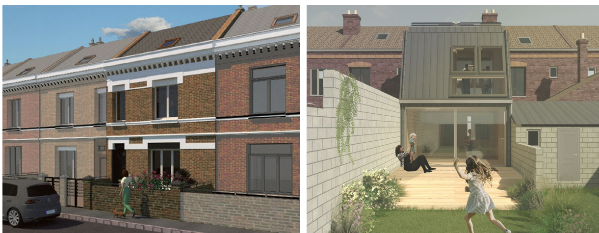
Figures 50 et 51 : Exemple d'extension rapportée sur la façade arrière d'une maison
