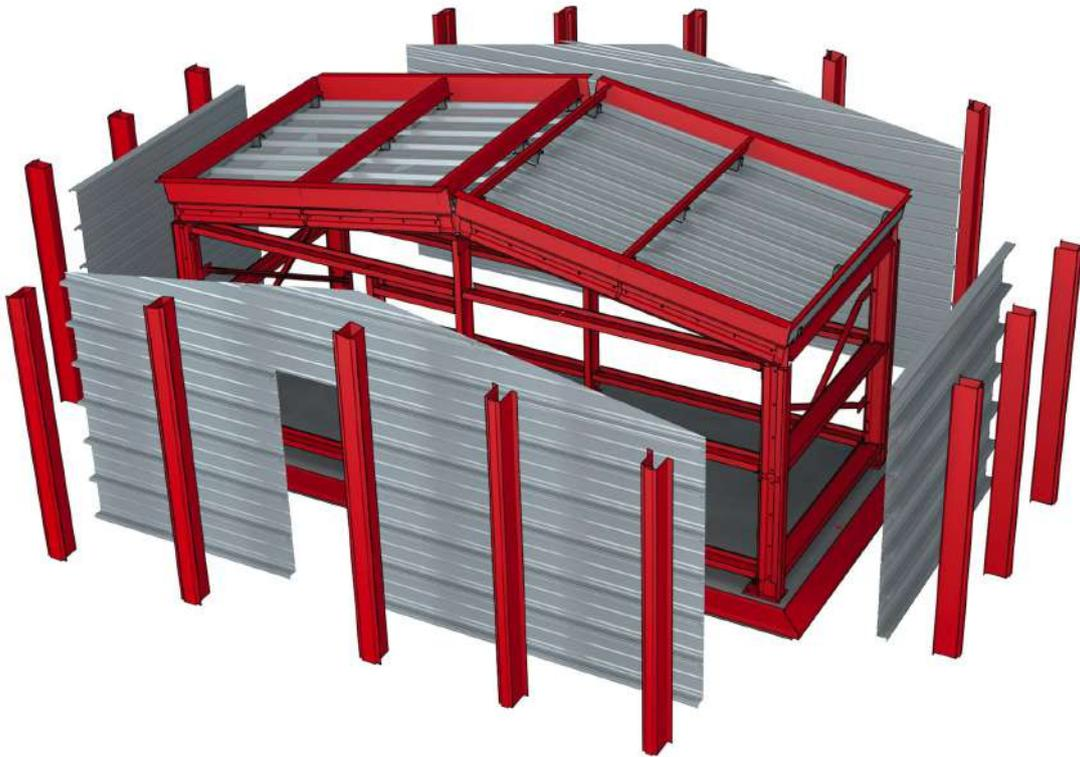
FIG 12-B Vue en éclatée des composants de l'enveloppe métallique
