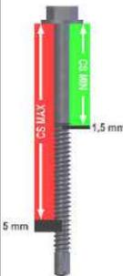
(8) **Longueur des vis et capacité de serrage :**
