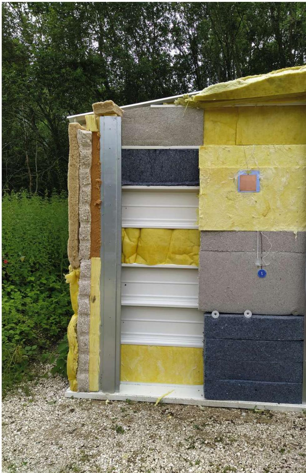
PHOTO 9\_D Vue des plateaux, oméga et isolants après démontage de la peau extérieure
