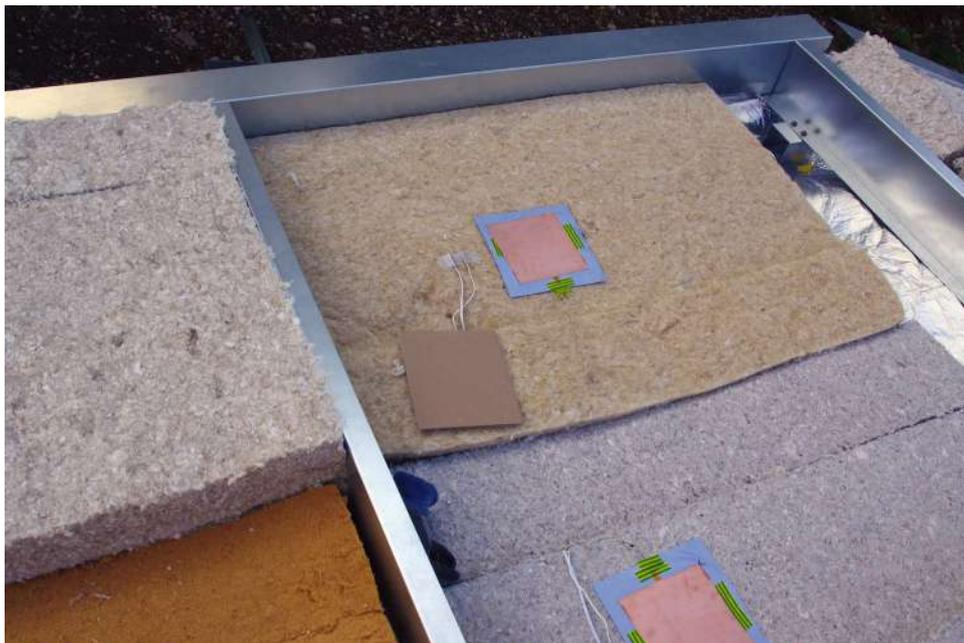
PHOTO 18\_C Détail des capteurs positionnés au sein des isolants
