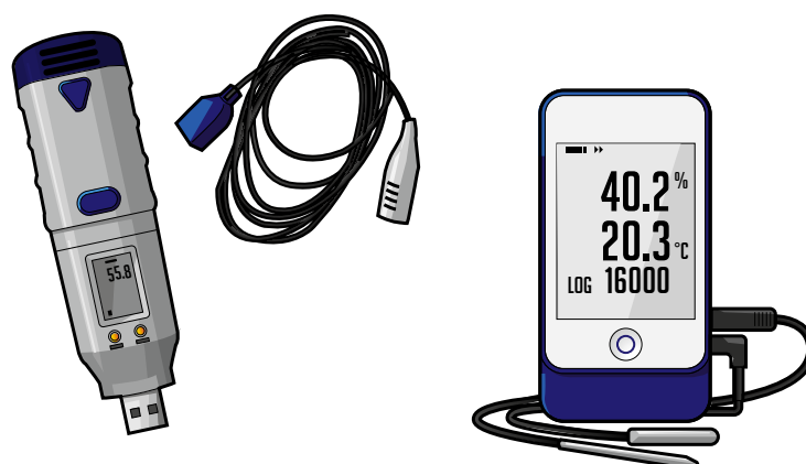
FIGURE 13B Dispositif de mesure de la température et de l'humidité
