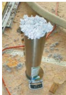
Échantillon de vérification de la densité. ©AQC-2015
