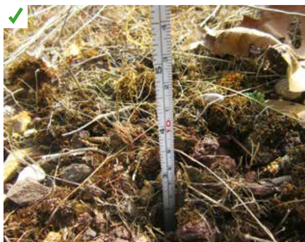
Le mélange de briques concassées contenant 30 % de compost et mis en œuvre avec une épaisseur suffisante, reconstitue les caractéristiques d'un sol propice à l'installation durable du couvert végétal. ©AQC
