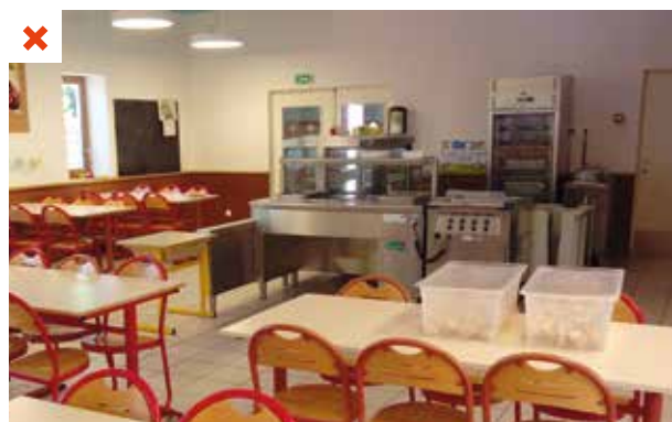
La chaleur dégagée par le matériel de cuisine entraîne une surchauffe dans la salle de restauration. ©AQC
