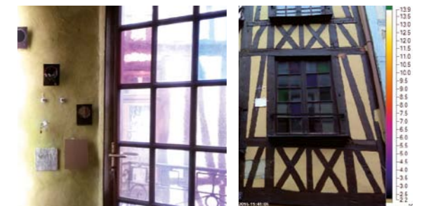
Mesures des températures de rayonnement réfléchi et d'air en intérieur et en extérieur (Rouen 2015 projet FaHeBA)
