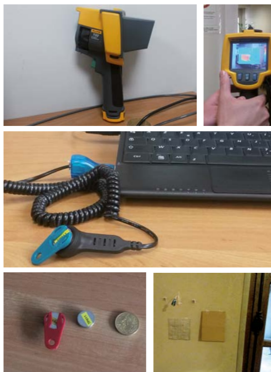
Caméra thermique portable haute définition et thermo-puces utilisées dans le cadre du projet FaHeBA (thermo-puces avec leur lecteur et thermo-puces collées sur un mur intérieur).
