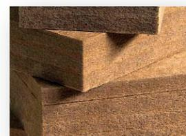
planchers. En revêtement extérieur (en panneaux, lames et bardeaux), il sert à protéger le bâtiment des intempéries. Le bois s'utilise également en isolant sous forme de fibres ou de laines qui présentent de bonnes qualités d'isolation et laissent circuler la vapeur d'eau, permettant ainsi de réguler l'hygrométrie intérieure des bâtiments. La Champagne-Ardenne dispose d'un gisement de bois disponible conséquent.
