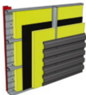
Étanchéité avec membrane pare-air
