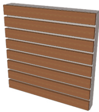
Figure 10 : Configuration 1.1 - Hauteur de référence (Ze) = 10 m / Epaisseur minimale des lames (mm) en fonction de la portée et de la pression de vent
