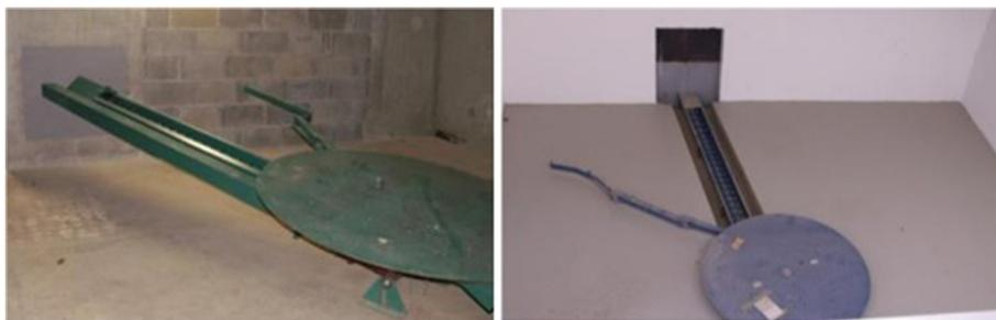
▲ Figures 38 : Exemples de système d'extraction rotatif sans et avec plancher
