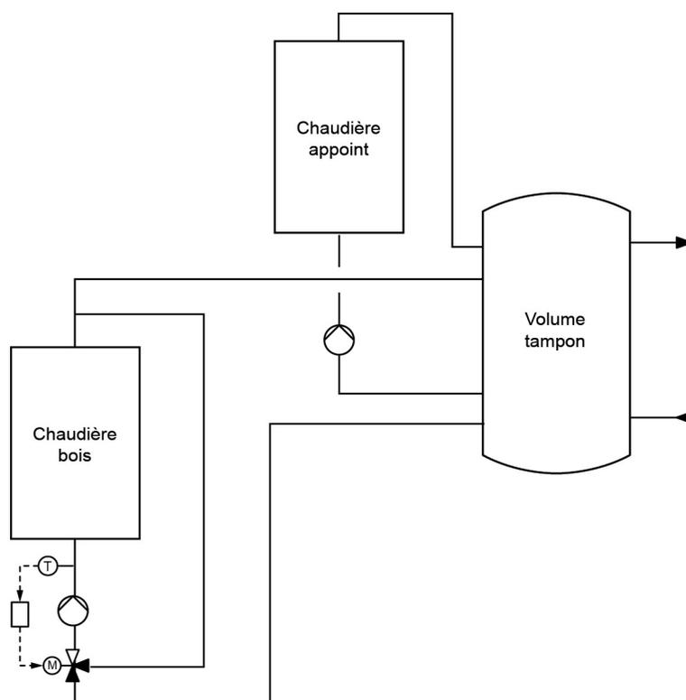
▲ Figure 55 : Exemple d'installation avec une chaudière bois et une chaudière d'appoint raccordées sur un ballon d'hydroaccumulation en quatre piquages
