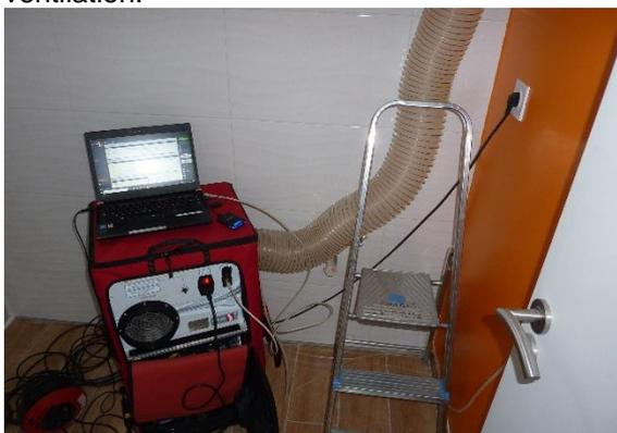
FIGURE 10 : MATERIEL DE MESURE D'ETANCHEITE A L'AIR
